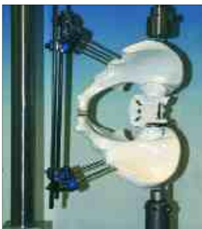
Abb. 16: Becken mit Zugstangen in Testmaschine eingespannt
