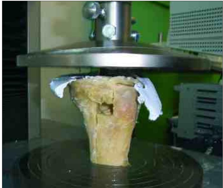
Abb. 3: Operierte Tibia in der Zwick-Universalprüfmaschine unmittelbar nach Eintreten der Fraktur.
